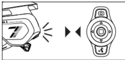
将开机的闪控靠近主控，预警灯出现 3 次 /S 的闪烁，表示有闪控需要接入头盔。
